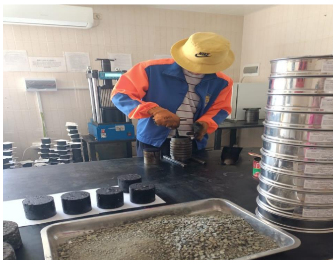
Рисунок 2. Внешний вид переформованных образцов
