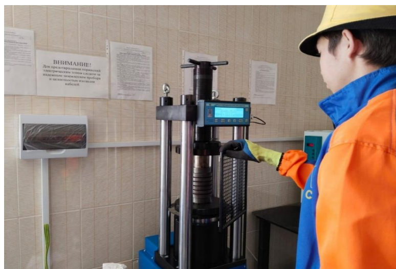
Рисунок 3. Уплотнение смеси на гидравлическом прессе
